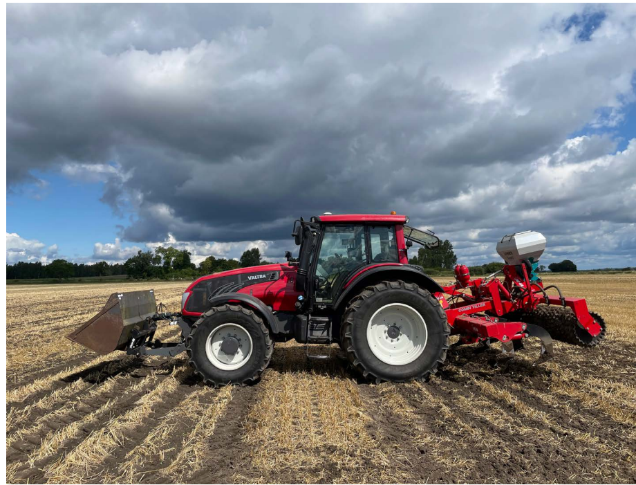
Heva Combittiller utrustad med frölåda anpassad för sådd av mellangrödor.
