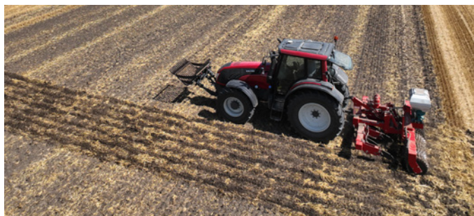
Bild 1. Traktor och Heva Combitiller utrustad med frölåda anpassad för sådd av mellangrödor.
