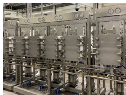
De nya hydrocyclonerna är likt stora delar av fabriken levererad av GLarsson i Bromölla.
